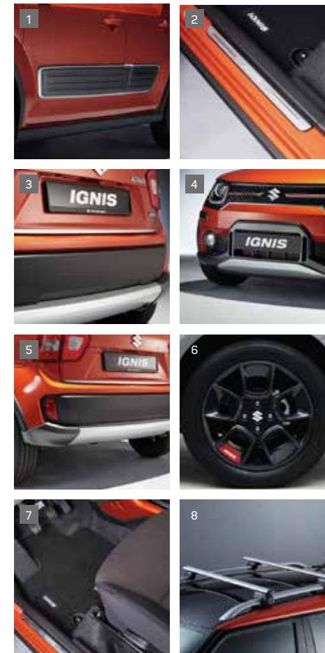
1 Moulure large de carrosserie latérale. 2 Protecteurs de seuils de porte. 3 Moulure de hayon arrière. 4 Plaque de protection avant. 5 Plaque de protection arrière. 6 Autocollant pour roue 16" d'origine (rouge, orange, bleu et blanc). 7 Jeu de tapis de sol "DLX". 8 Galérie de toit.
