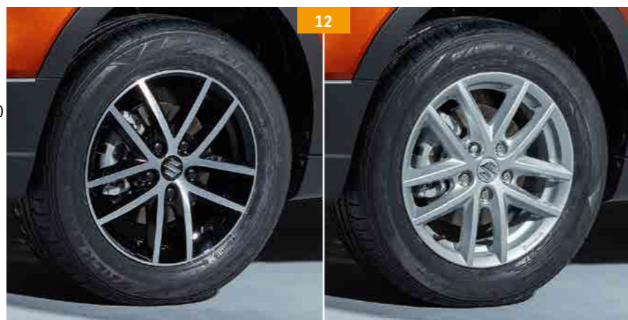
12 | ALUMINIUM VELG "Gobi" 6,5 J x 16" Aluminium velg zwart gepolijst 6,5 J x 16", geschikt voor 215/60 R16-banden, inclusief naafkap met Suzuki-logo.
