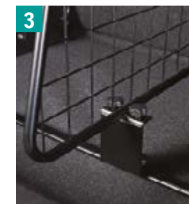
3 | Adaptateur pour grille de séparation du coffre Pour fixer la grille de séparation (en longueur) dans la position inférieure du plancher de coffre Réf. pièce 990E0-54P48-002
