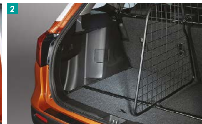
2 | Grille de séparation du coffre en acier, pour diviser le coffre en deux, uniquement en combinaison avec la grille de séparation du coffre (réf. pièce 990E0-54P48)
