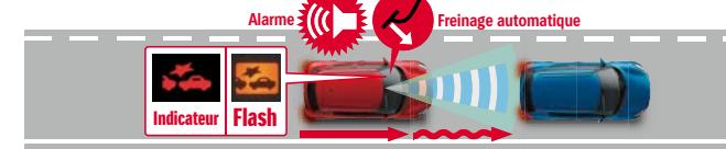
3. Applique un freinage automatique puissant si le risque de collision augmente encore.
