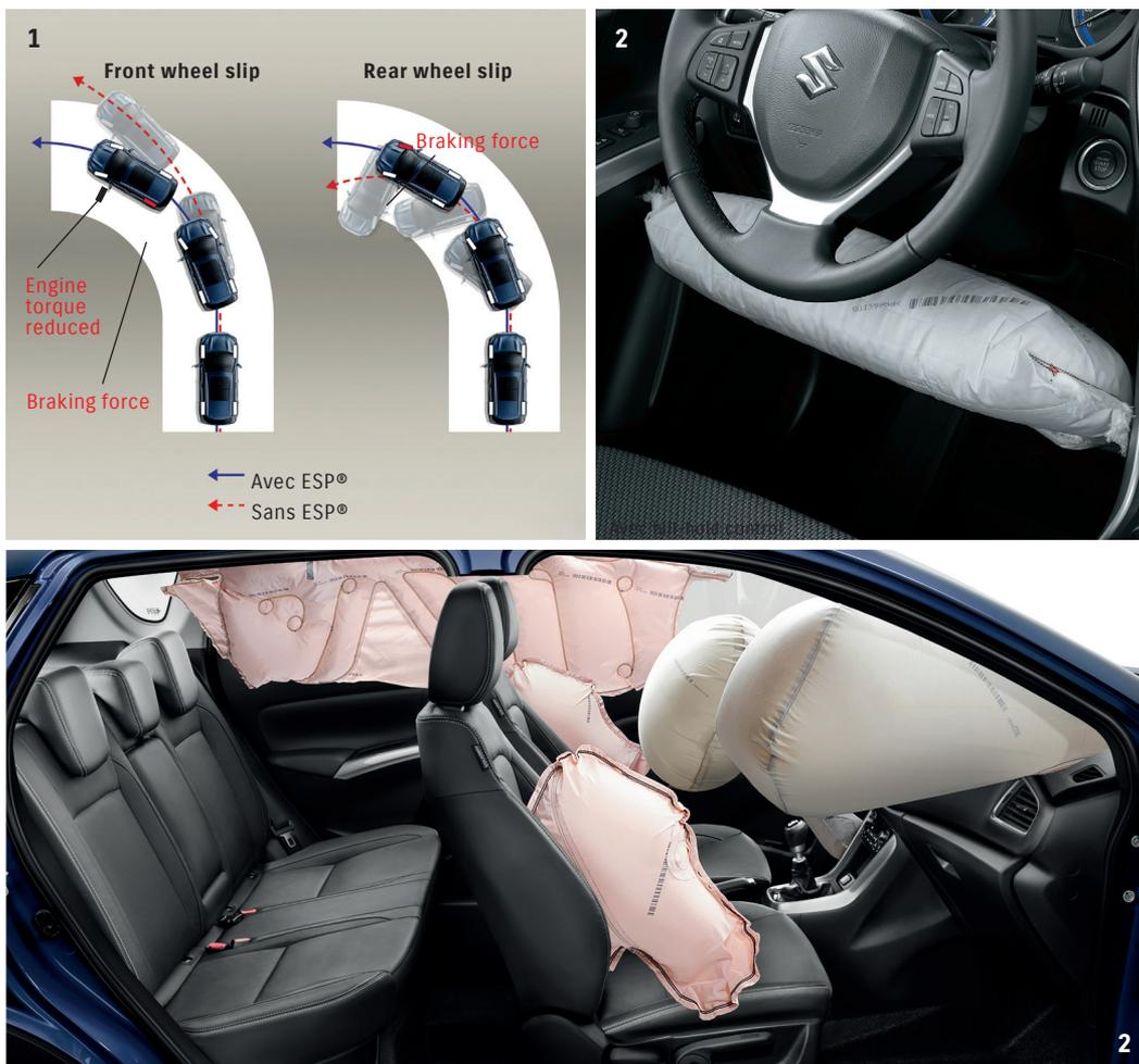
**1 Electronic Stability Program® (programme électronique de stabilité, ESP)** Lorsque les roues perdent leur adhérence, le programme électronique de stabilité ESP®\* intervient automatiquement au niveau du moteur et des freins pour permettre au conducteur de garder le contrôle.
